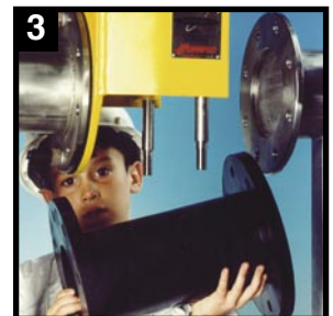
3 Remover manga gastada y reemplazar por nueva
