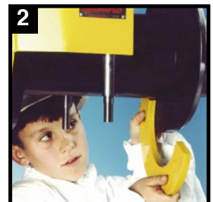
2 Retirar pernos de flanje y flanges de apoyo
